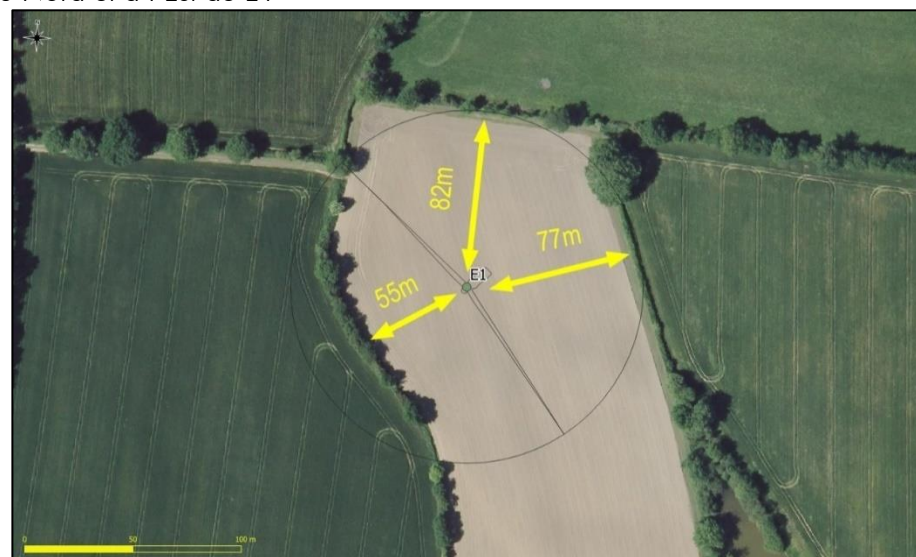
Distance entre le pied de l'éolienne E1 et les haies les plus proches Source : Les Snats, 2021
