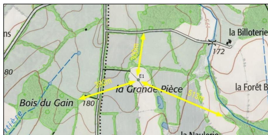
Distance entre le pied de l'éolienne E1 et les lisières les plus proches Source : Les Snats, 2021
